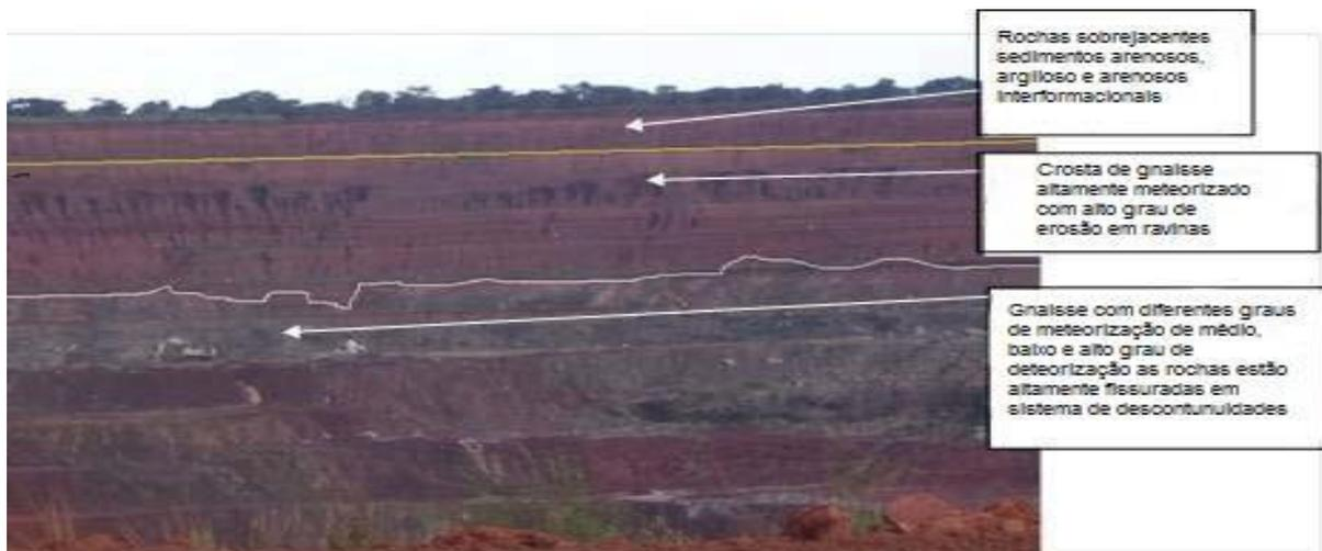
Figura 10- Distribuição dos sedimentos sobrejacentes, o gnaisse segundo a sua meteorização e descontinuidade.
