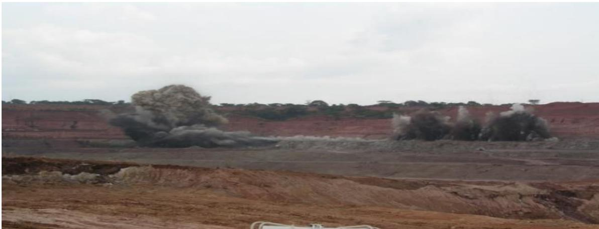
Figura 12- Desmonte dos gnaisses com explosivos.
