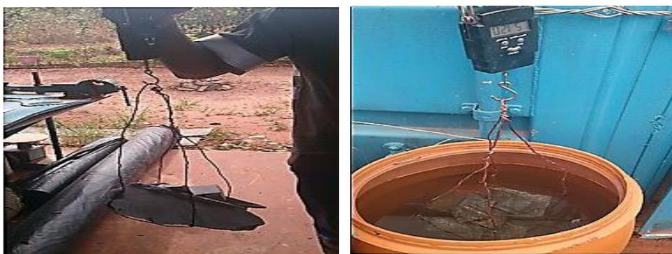
**Figura:** 20 Pesagem da amostra seca e na água por meio da balança hidrostática
