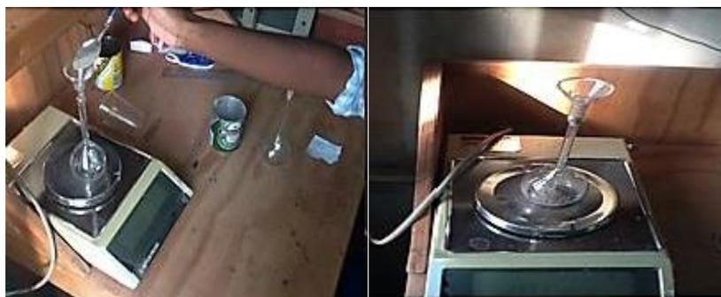
**Figura 26:** Pesagem do picnómetro com as amostras
