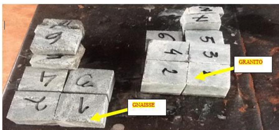
**Figura 21:** Amostras de granito e gnaiss usadas no ensaio
