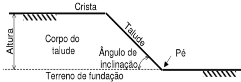
**Figura 1:** Talude com os seus parâmetros
