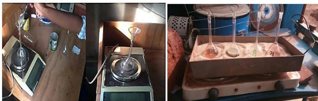
**Figura 27:** Pesagem do picnómetro **Figura 28:** Picnómetros no aquecedor.
