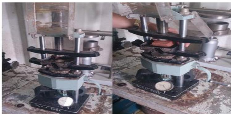
**Figura 24:** Ensaio de resistência à tração do material com o aparelho viking.
