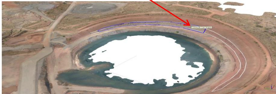
**Figura 6:** Zona de ruptura de um talude na mina de Catoca (Fonte: Catoca)
